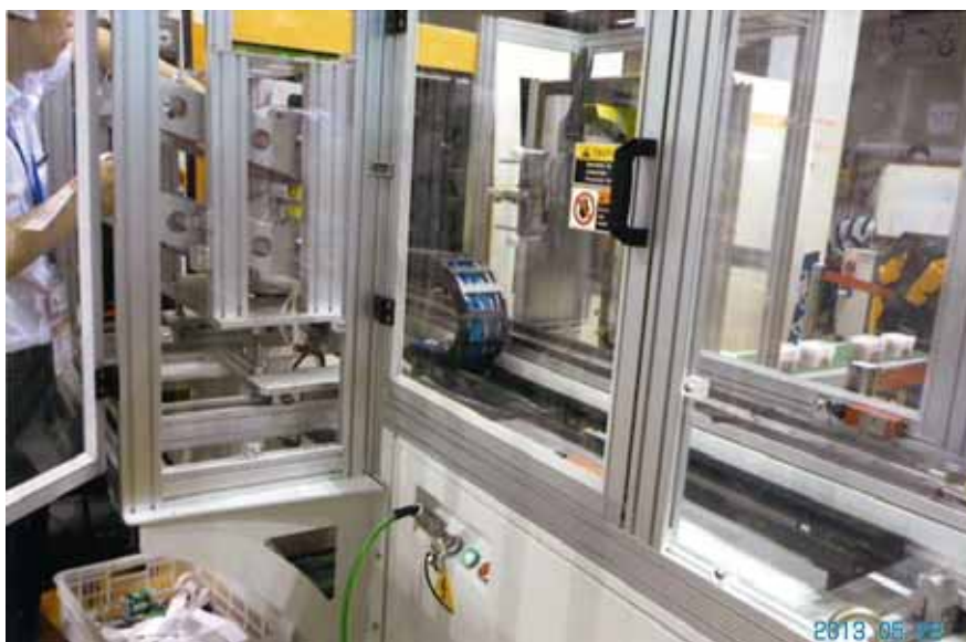
写真-16 【印刷ラベルをサンドイッチして射出ライン】
