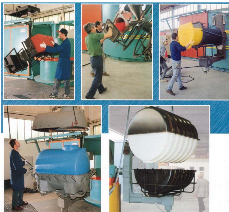
写真 14 CACCIA社の回転成形物の金型からの取り出し
