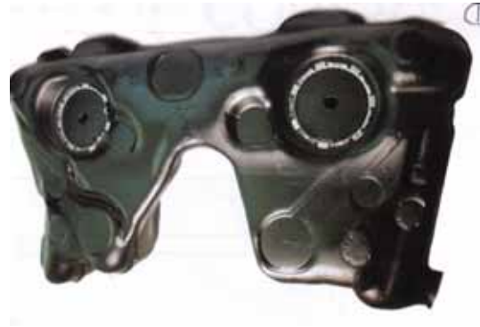
図 11 加熱圧縮成形法による燃料タンク (Cannon)
