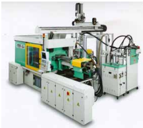
図 22 ナイロンと LSR との 2 材質を射出するユニット (ARBURG)
